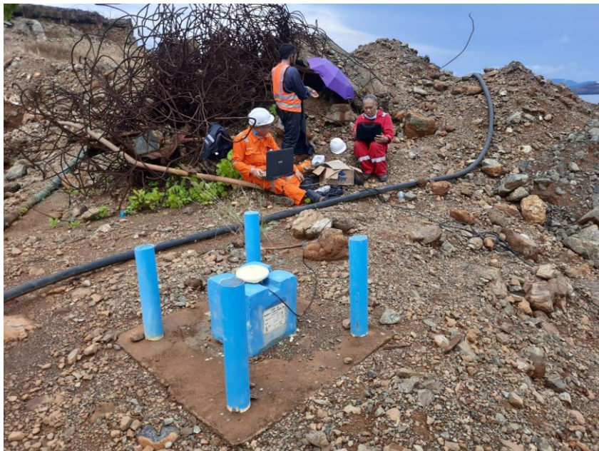
Gambar 1. Verifikasi GPS ke BM (Bench Mark)
