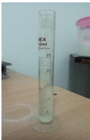
Gambar 2 Hasil Filtrat Lumpur 1 Selama 25 Menit
