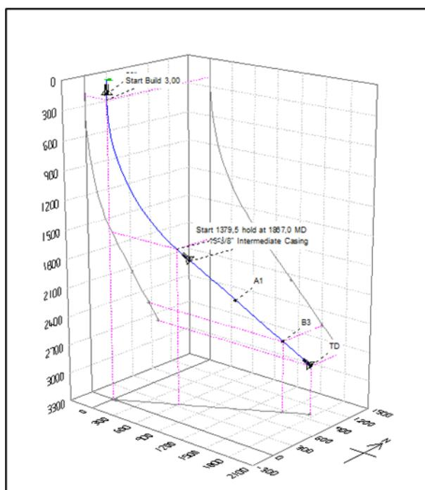
Gambar 10. Perencanaan Trajectory Sumur MST-01 3D View
