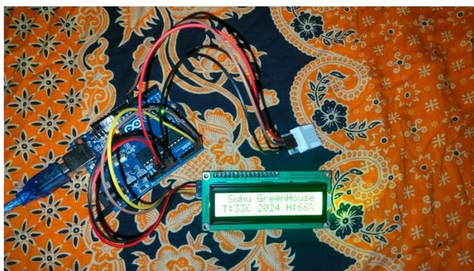
Gambar 3. Rangkaian Perakitan Sensor DHT 22
