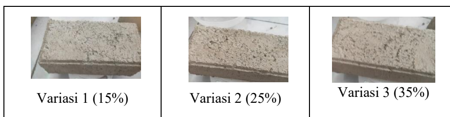
Gambar 3. Variasi Komposisi Lumpur Pada Paving Block
