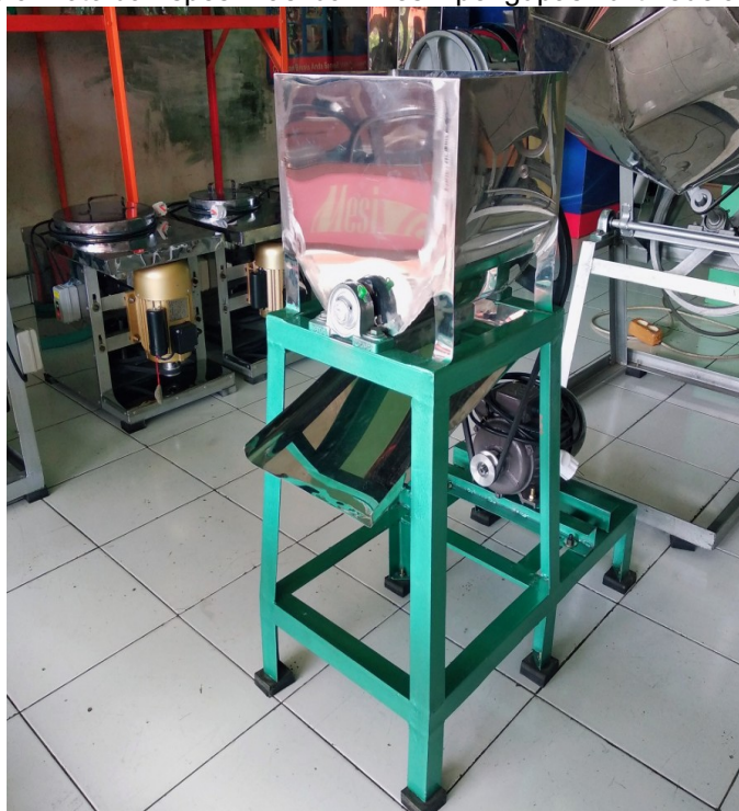
Gambar 3. Alat Pengupas Kulit Kedelai
