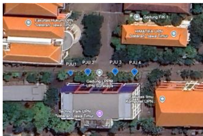
Gambar 2.1 Titik Pemasangan PJU Sumber: Google Maps
