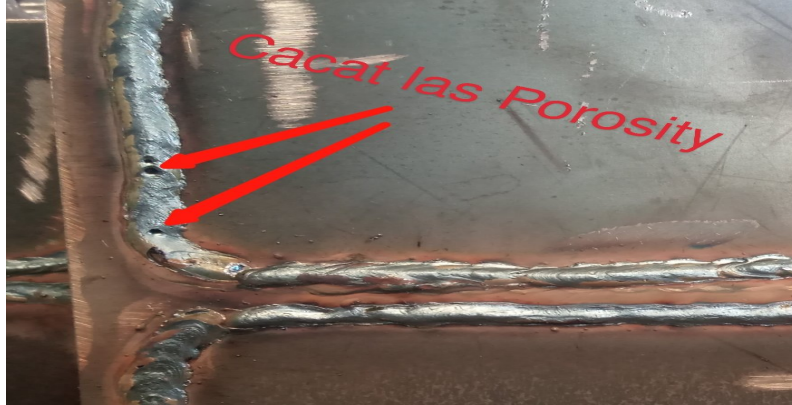
Gambar 4. Cacat Las Porosity
