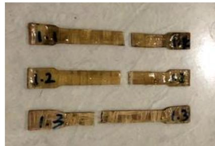
Gambar 3 Spesimen saat setelah diuji Tarik
