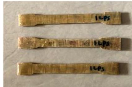
Gambar 2 Spesimen saat sebelum diuji tarik
