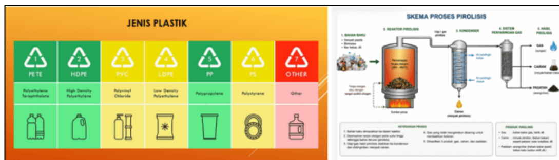
Gambar 3. Klasifikasi jenis plastik dan teknologi Petasol (Proses Pirolisis) sebagai bahan bakar alternatif
